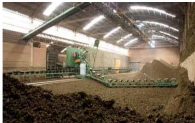
Экскаватор машина, пригодная для восстановления материала из бункера ранее уложены с помощью системы конвейерных лент. Он состоит из огромной руки которая держит ковшы, экскаватор построен с крепкой сетчатой структурой, внутри которого движется цепь которая перемещает ковшы, которые имеют задачу выскабливание месторождение глины.
