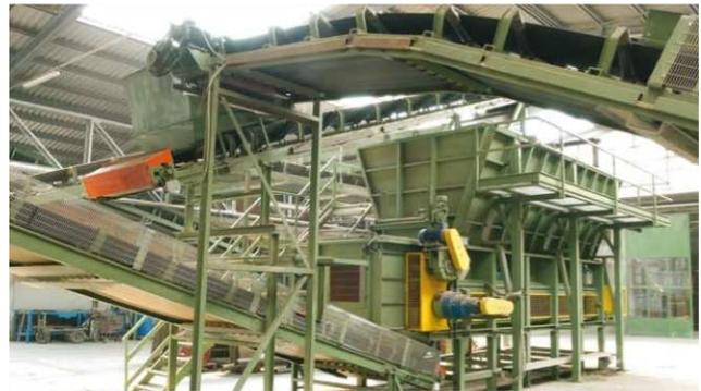
**Конвейерные ленты** изготавливаются из прочного металлического каркаса (трубчатые, УНП и листовые) полностью модульная и сделанный разной длины и ширины, чтобы дать функциональное и быстрое реагирование на потребность клиентов.
